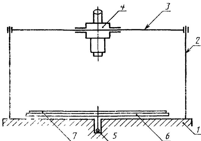
1 — основание; 2 — стойка; 3 — направляющая, 4 — микроскоп с подсветкой, 5 — опора, 6 — диск, 7 — пластина
