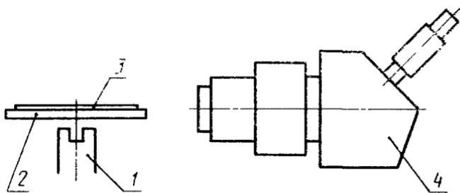
1 — база; 2 — диск базы; 3 — пластинка; 4 — оптический микроскоп
